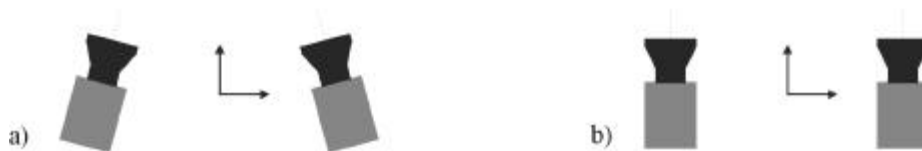
Bild 2 : Rektifizierung: a) reale Kameraanordnung b) Standardanordnung
